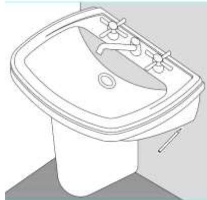
8- Remover o lavatório e a coluna, furar a parede com broca apropriada nos pontos marcados e colocar as buchas plásticas com seus respectivos parafusos. Montar o lavatório com as respectivas porcas e arruelas, montar as conexões de água e esgoto, fixar a coluna com as respectivas porcas e arruelas. Dar acabamento com material de rejunte.
